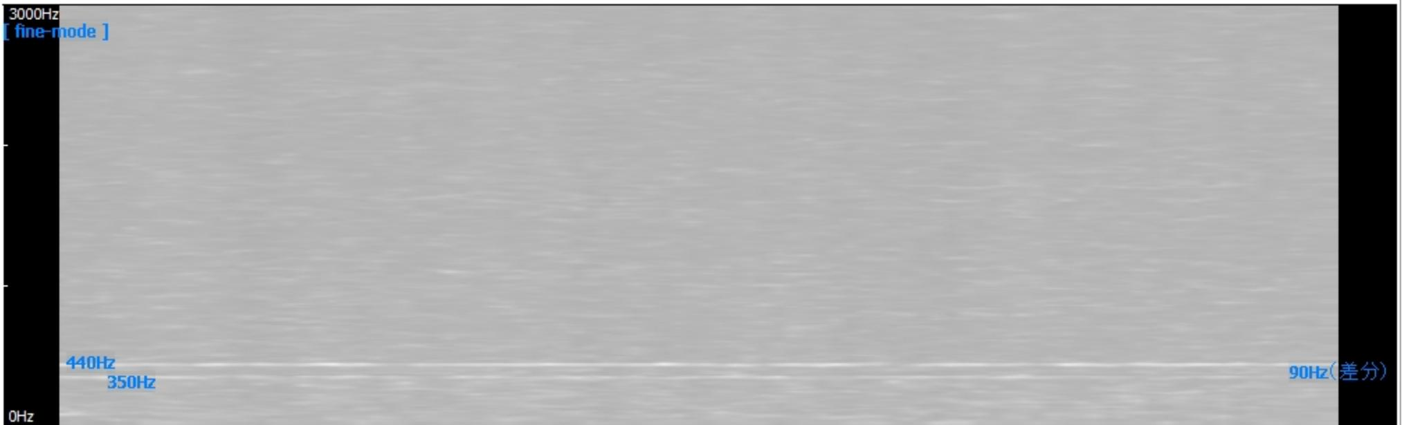
440Hzと350Hzの差分である90Hzとそのn倍の周波数の混変調歪みが除去されている
